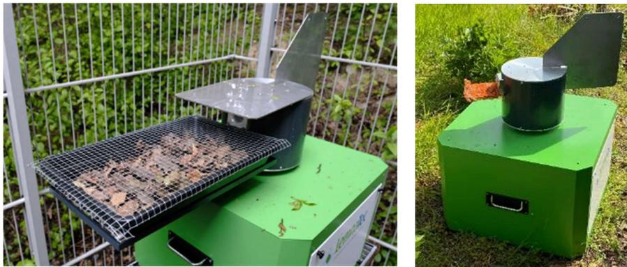
Abbildung 8. Fotos der beiden ersten Prototypen des ApfelPathosensors. Beide mit unterschiedlichen Modifikationen für die Aufnahme für infizierte Apfelblätter („Booster-Schale“), als Quelle für das Sporenschleudern. Links wurde ein Rahmen mit einer großen Schale für viele Blätter angebracht, überspannt war das Ganze mit einem Drahtgeflecht. Rechts war eine kleinere Fläche für wenige Blätter angebracht, das Ganze war mit einem Netz gesichert.
