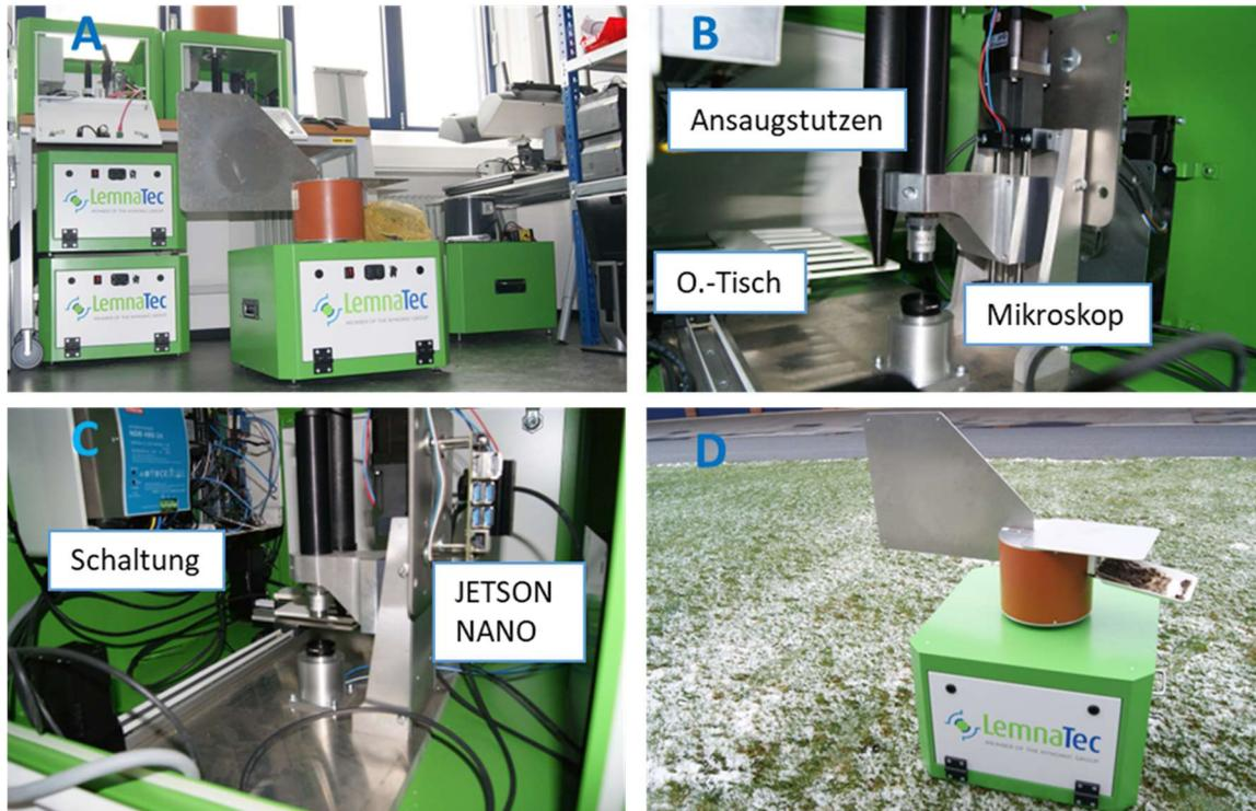
Abbildung 9. Finale technische ApfelPathosensor-Prototypen. A) Sechs Prototypen in verschiedenen Fertigungsstufen. B) Ansaugstutzen, Mikroskop und beweglicher Objektstisch im Inneren des ApfelPathosensors C) Jetson Nano mit Anschlüssen und Schaltkasten D) einsatzbereiter ApfelPathosensor
