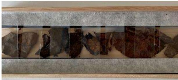
Abbildung 6. Foto eines mit infizierten Apfelblättern bestücktem Sporenbretts. Zum Mikroskopieren der ausgeschleuderten Ascosporen sind in einem Abstand über den Apfelblättern Objektträger angebracht. Diese wurden während der Saison regelmäßig entnommen, im Labor mikroskopiert und gegen neue Objektträger ausgetauscht.
